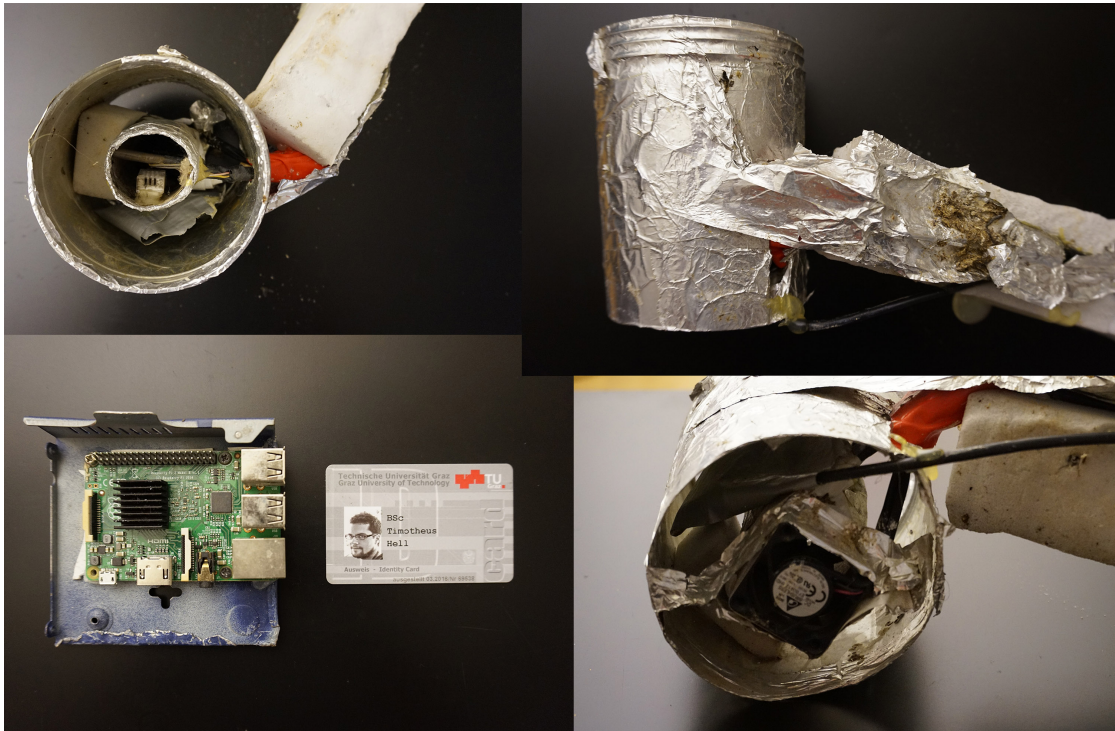
Abbildung 7.3.: Fotos von äußerem und innerem Rohr mit den Sensoren und Lüfter, sowie vom RPI 2 auf gebrauchtem Gehäuse eines Netzwerkschwitch montiert. Nach 2 Jahren im Außeneinsatz etwas lädiert, aber voll funktionstüchtig.
