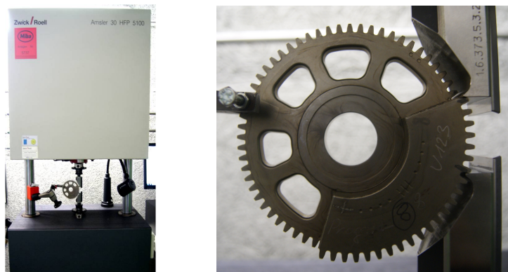
Abbildung 6.1.: Links: Hochfrequenzpulsator von Zwick/Roell; rechts: Prüfgeometrie T1, eingespannt im HF Pulsator
