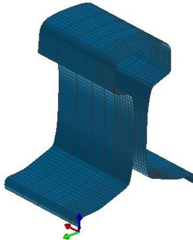
Abbildung 36 Einhüllende der Schiene aus 2D Elementen
