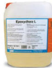
R&G Epoxydharz L ist ein Bisphenol A/F-Harz. Bisphenol F verringert die Viskosität und verhindert das Auskristallisieren des Harzes bei niedrigen Lagertemperaturen (unter + 5 °C).
