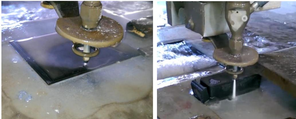
**Abbildung 67: Wasserstrahlschneiden Ferrit**
