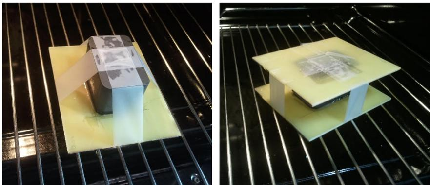
**Abbildung 68: Ankleben der Glasfaserplatten**
