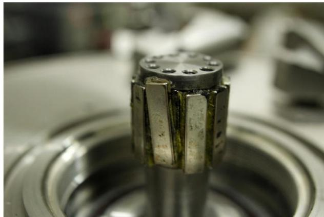
**Abbildung 12: Versagen der Magnetkupplung**
