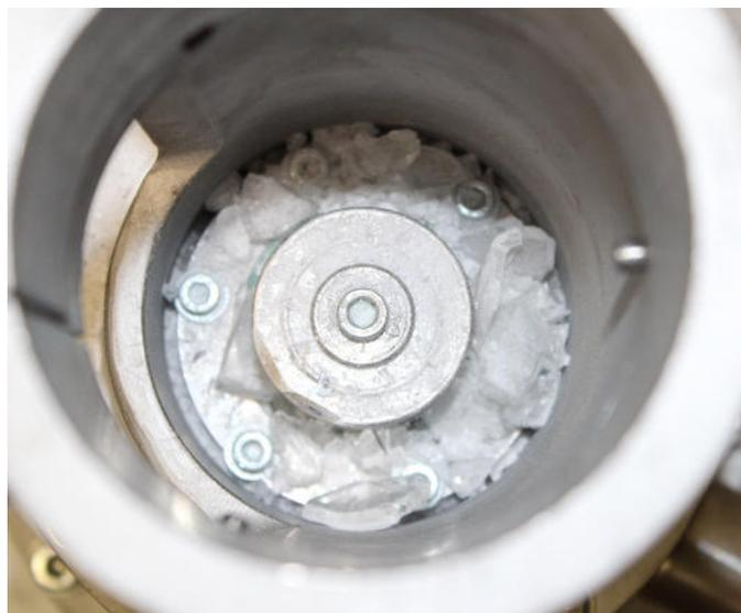
**Abbildung 24: Zerstörung durch Resonanz (Burgholzer, 2014, S. 65)**
