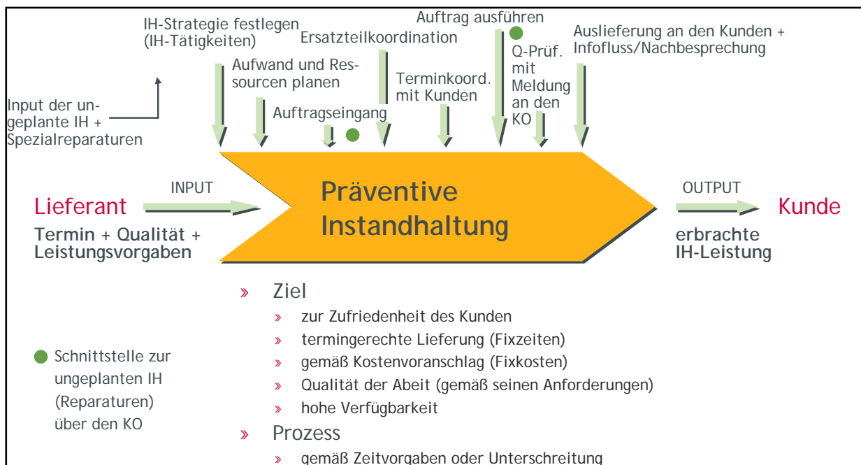
Abb. 4.20: Prozess der präventiven Instandhaltung bei der GKB 73
