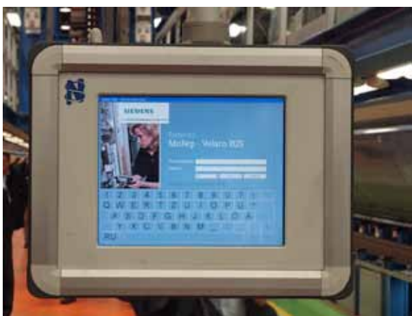
Abb. 4.11: Touchscreens zur Auftragsrückmeldg.
