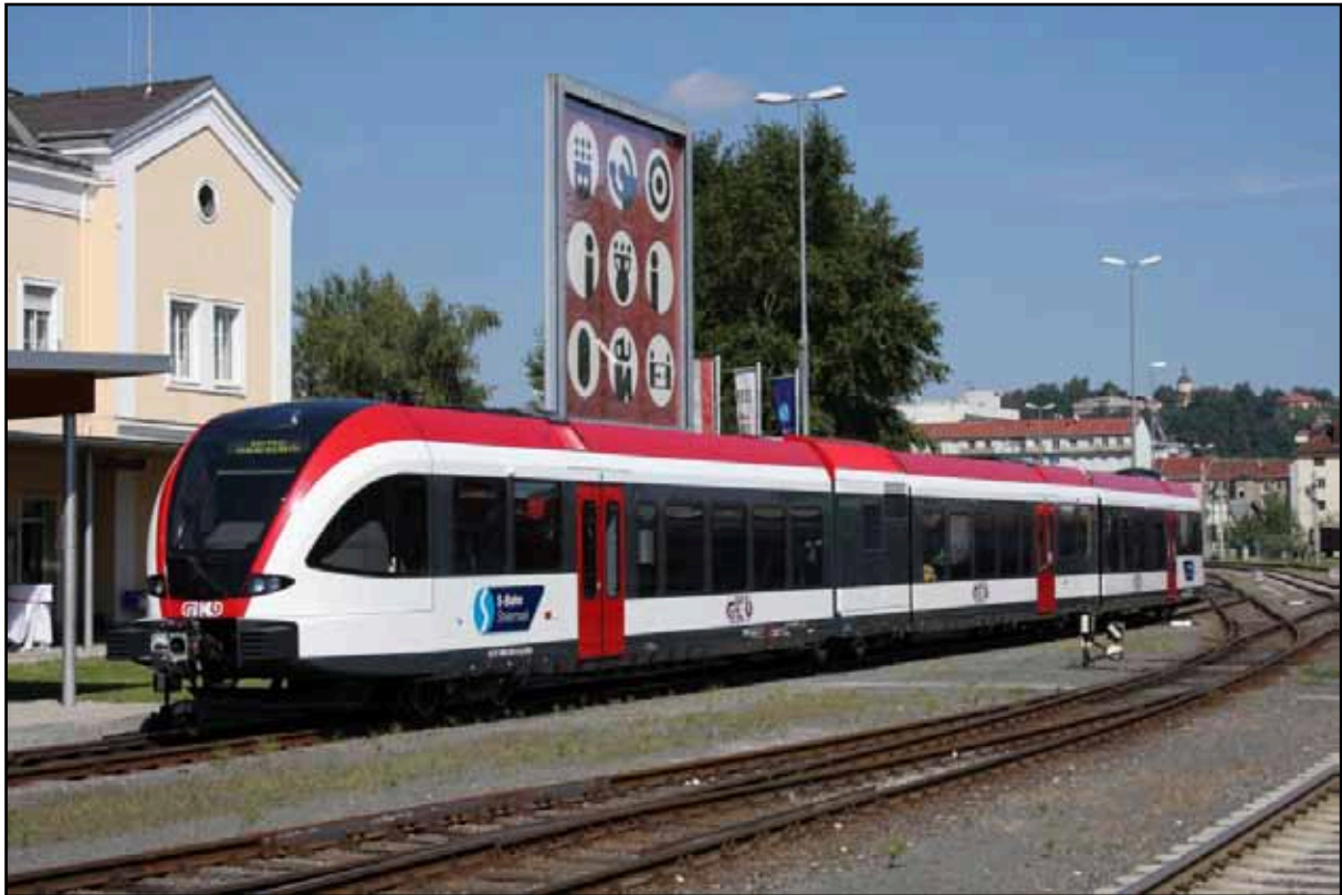
Abb. 1.2: Der neue dieselelektrische Triebwagen der Type Stadler GTW2/8 5
