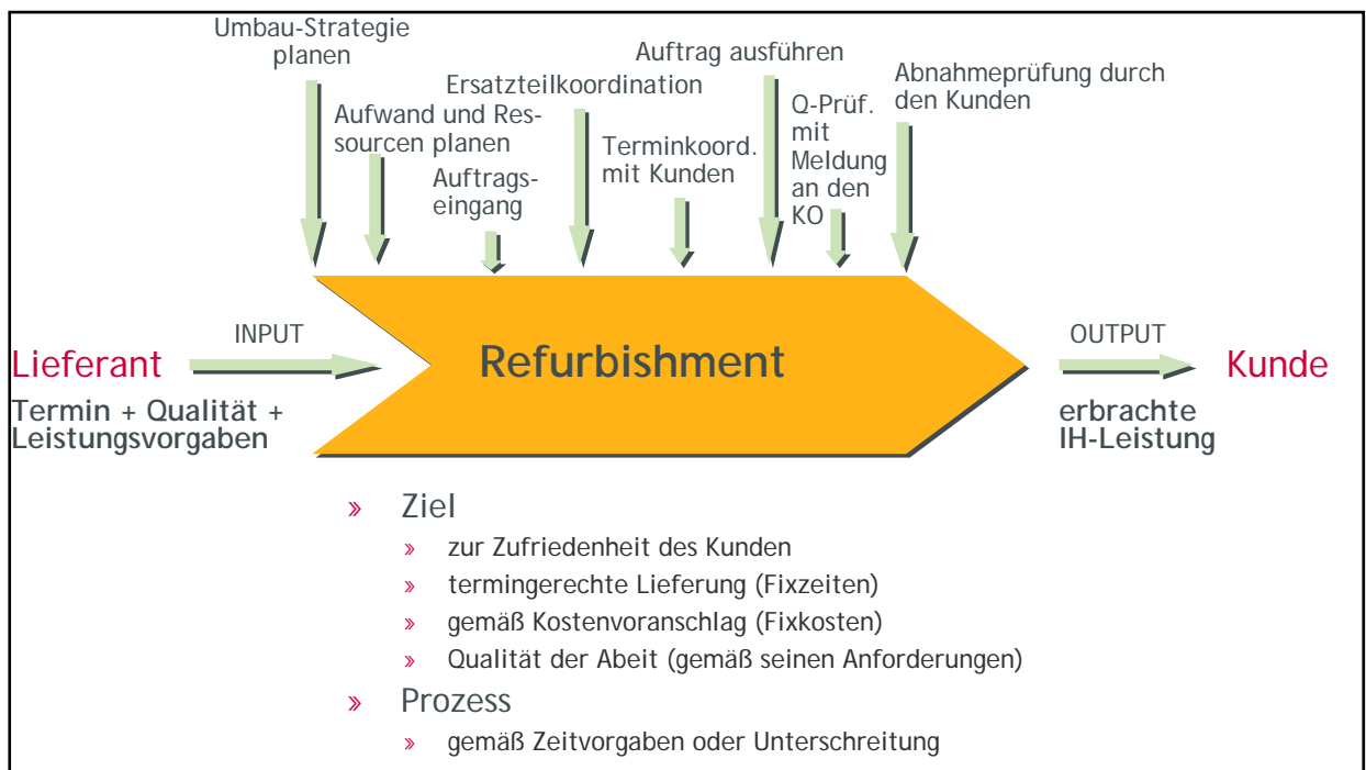
Abb. 4.24: Prozess des Refurbishments bei der GKB 81
