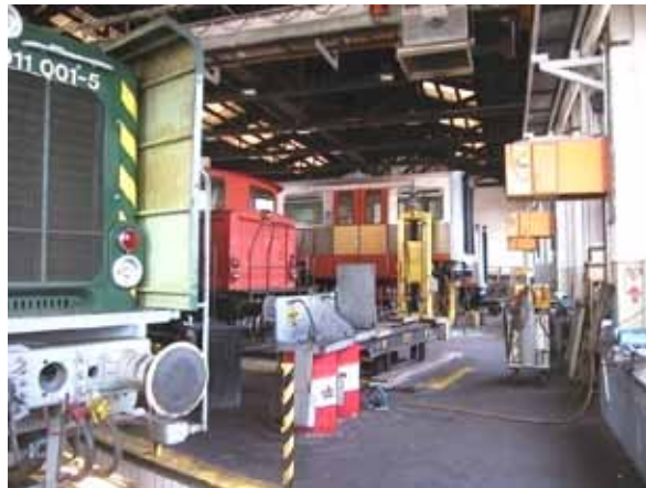
Abb. 4.1: Schwere Instandhaltung (HU, Revisionen) in der Halle der „Lokmontierung“
