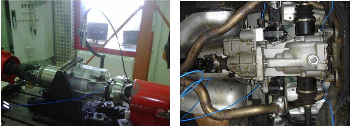
**Abb. 6.24:** Erprobung der Kupplung: (a) am 2-Maschinen-Prüfstand; (b) im Fahrzeug
