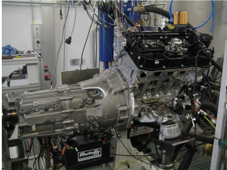
Abbildung 69: N20 mit abgebauter Peripherie
