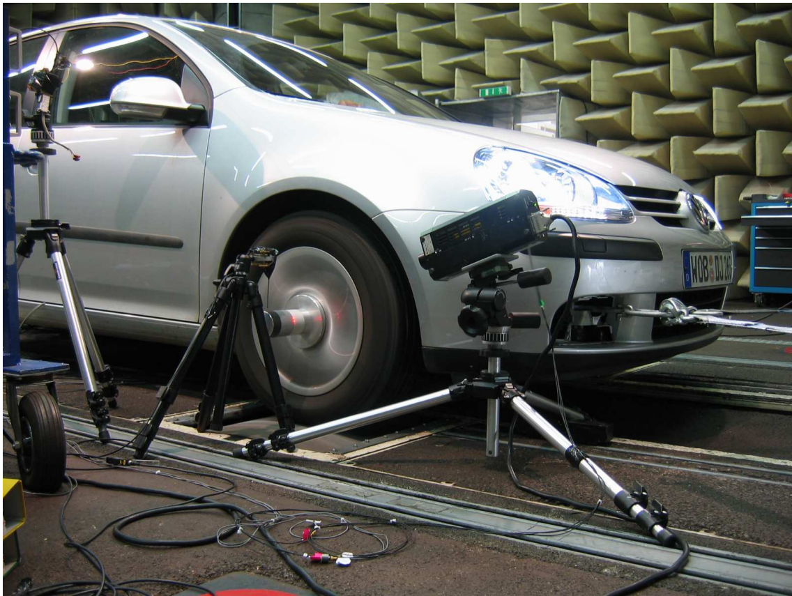
Abbildung 5.1: Aufgespanntes Versuchsfahrzeug am akustischen Rollenprüfstand mit applizierter Messtechnik
