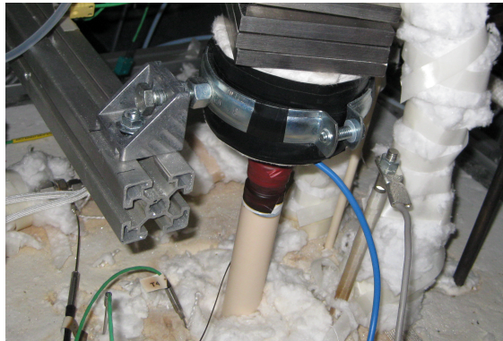
Abbildung 3.5: Zusatzgewichte zur Dichtung und Keramikrohr der Anode
