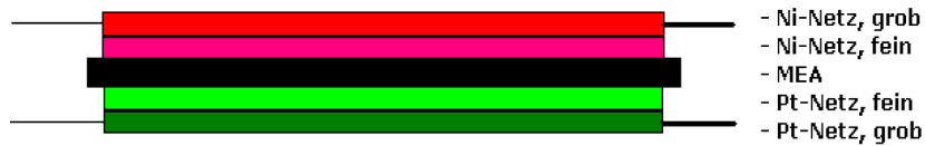
Abbildung 3.2: Aufbau MEA mit Nickel- und Platinnetze [15]
