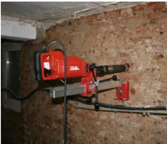
Abb. 4. 1: Probenentnahme mit Bohrmaschine [30]
