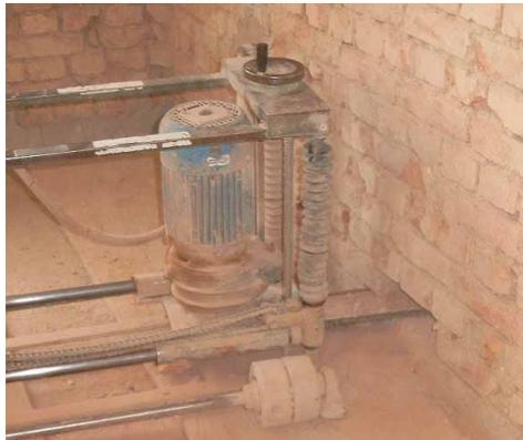
Abb. 5. 3: Trennung des Mauerwerks mit Mauerfräse[32]
