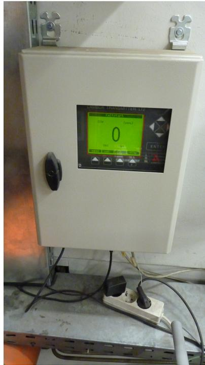
**Abbildung 5.4:** KS1D Auswerteelektronik
