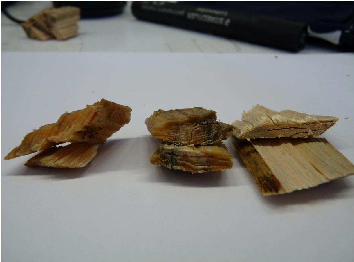
**Abbildung 6.5:** Stufen der Befeuchtung des Brennstoffes
