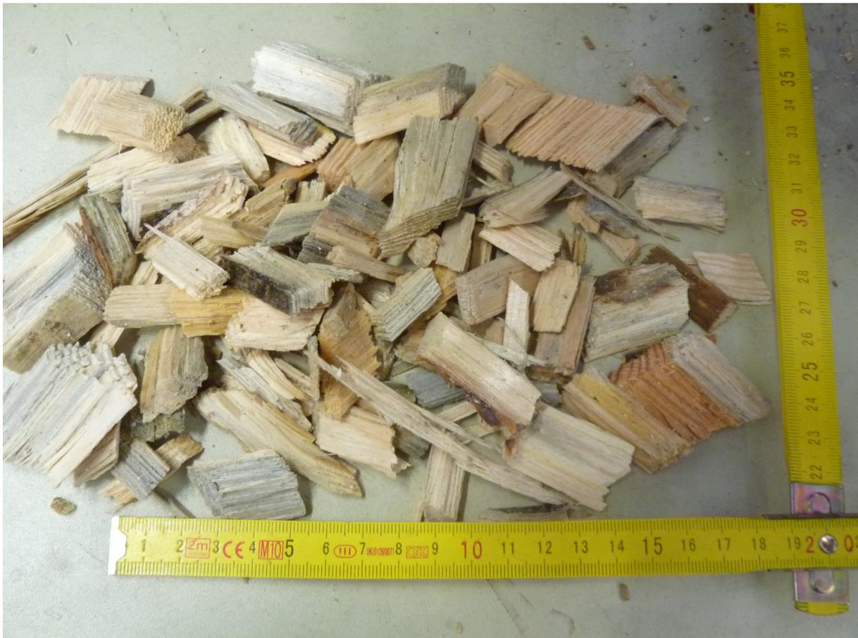
**Abbildung 6.1:** Brennstoffprobe des verwendeten Hackgutes
