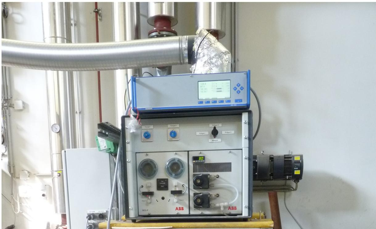
**Abbildung 4.4:** Rauchgasanalyseeinheit (oben) und Rauchgasaufbereitung (unten)
