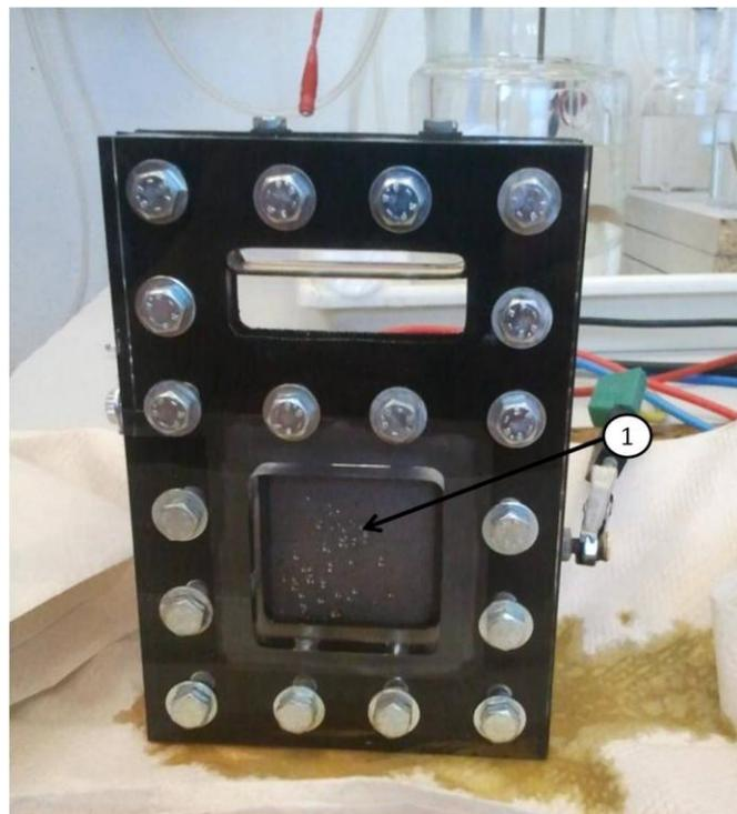
Abbildung 61: Elektrolytaustritt an der Sauerstoffelektrode (1)
