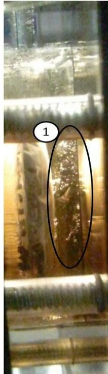
Abbildung 62: Sauerstoffentwicklung an der Innenseite der Elektrode (1)
