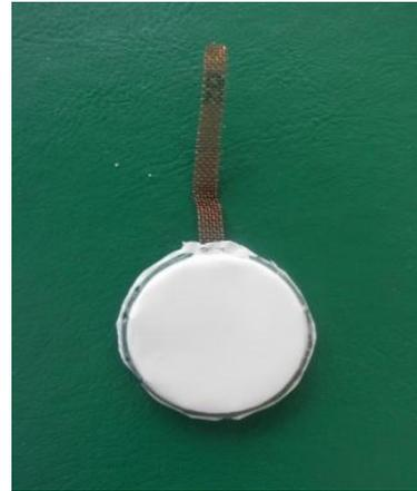
**Abbildung 20: Zinkelektrode mit Separatorfolie**
