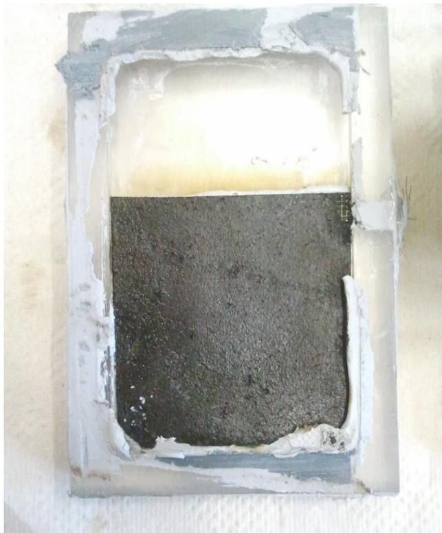
**Abbildung 65: Post mortem Analyse Sauerstoffelektrode Zelle 2**
