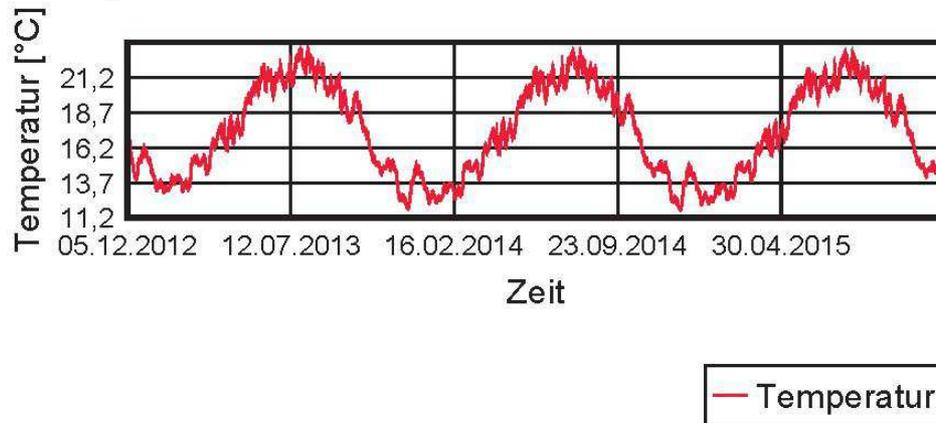
Abb. 77 Gemittelte Temperatur BSP Decke Detail-F
