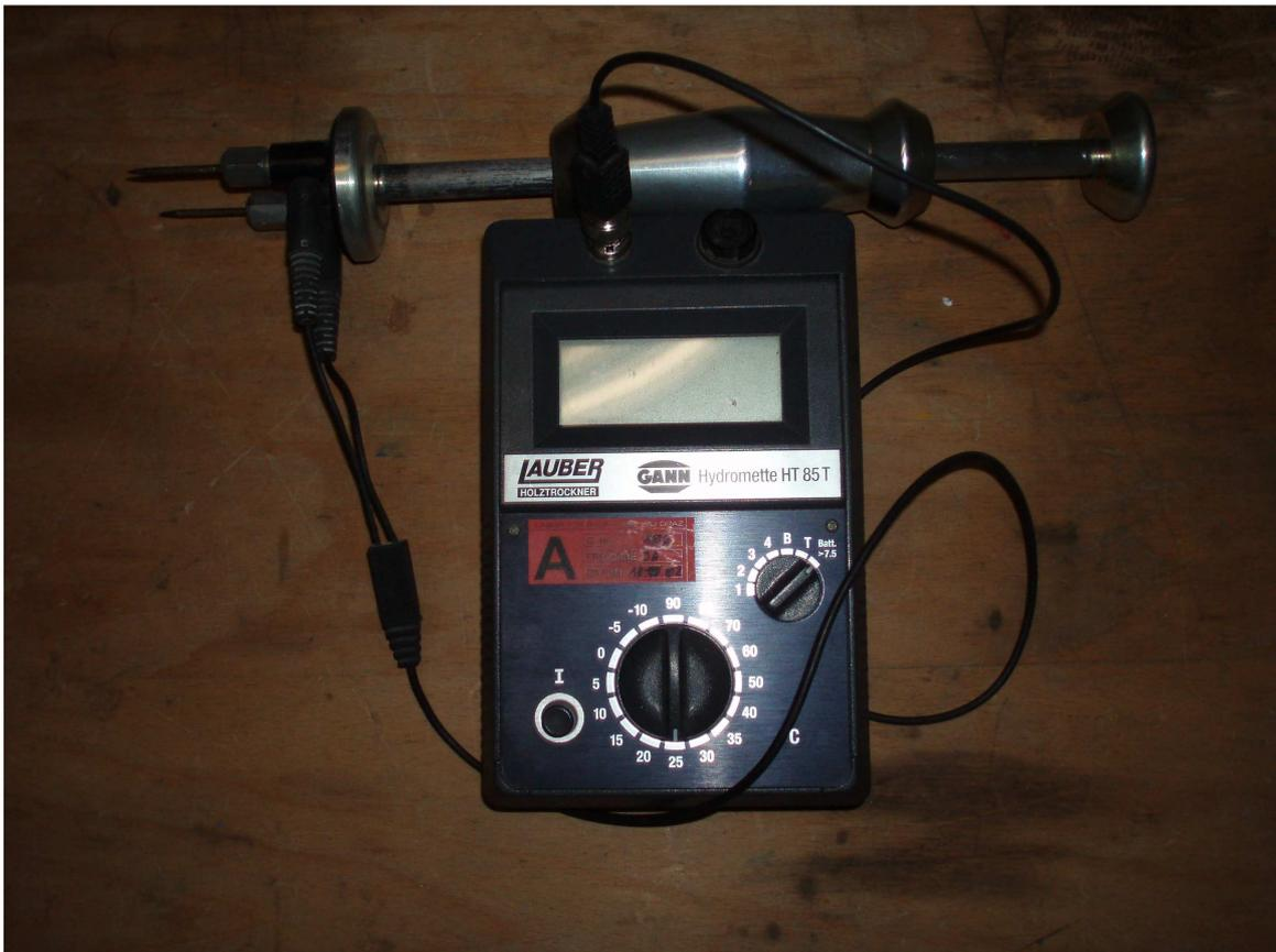
Abb. 48 Holzfeuchtemessgerät Hydromette HT 85 T der Fa. Gann mit Rammelektrode
