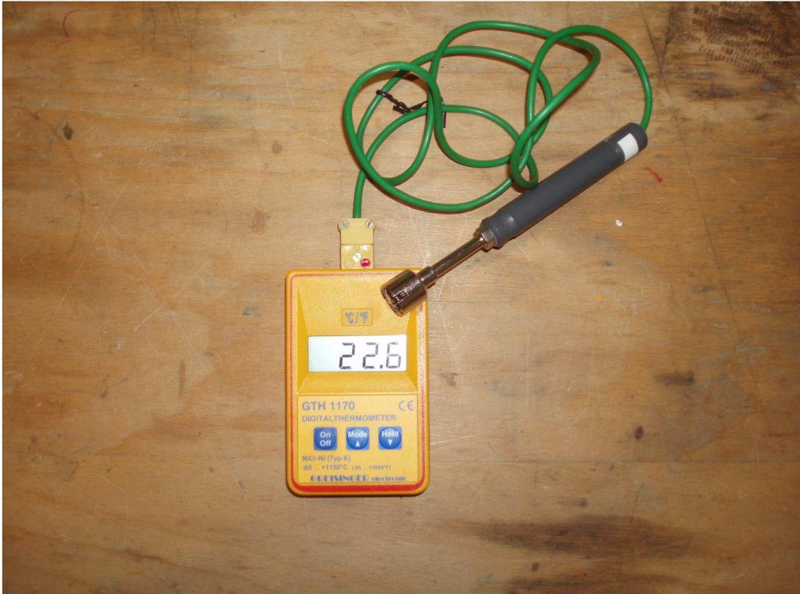
Abb. 49 Temperaturmessgerät GTH 1170 der Fa. Greisinger Elektronik
