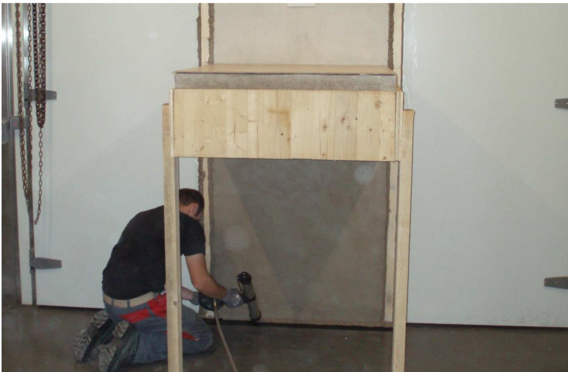
**Abb. 38** Abdichten der Anschlussfugen
