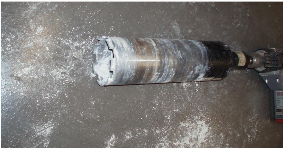
**Abb. 43 Kernbohrmaschine**
