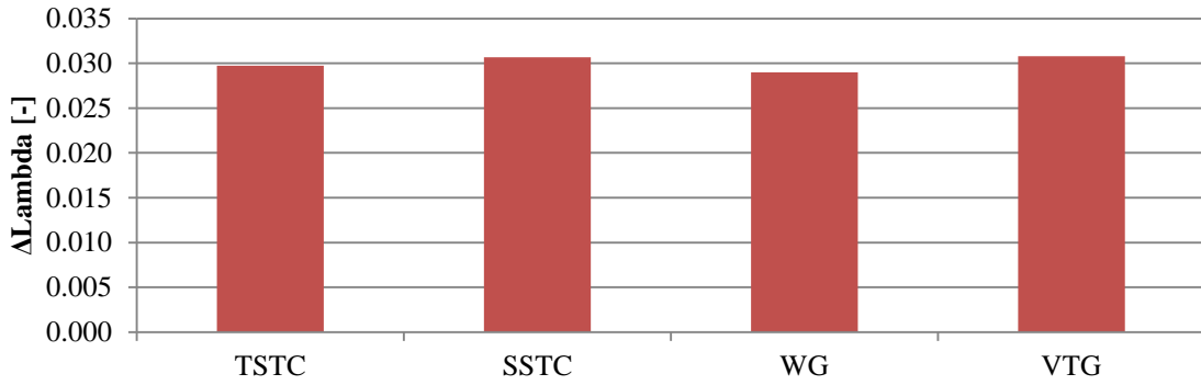
Abbildung 5.9: Änderung des Luftverhältnisses im Vergleich zu 1000 \text{ min}^{-1}
