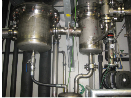
Abbildung 47: Kondensatsammelbehälter nach dem AGR Kühler und Tröpfchenabscheider (21) mit Leitung zum Kondensatauffangbehälter (5)
