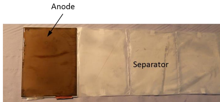
Abbildung 8.5: Anode als erste Schicht unterhalb des Separators (PROJEKT INTERN VSI TU GRAZ)
