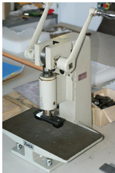
Abbildung 9.4: Stanzmaschine mit Stanzform der Probengeometrie (PROJEKT INTERN VSI TU GRAZ)
