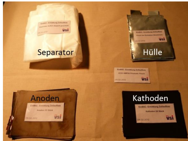
Abbildung 8.8: Komponenten der zerlegten Batteriezelle (PROJEKT INTERN VSI TU GRAZ)
