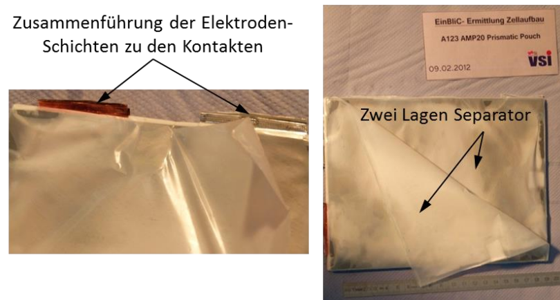
Abbildung 8.4: Zwei Lagen Separator (PROJEKT INTERN VSI TU GRAZ)
