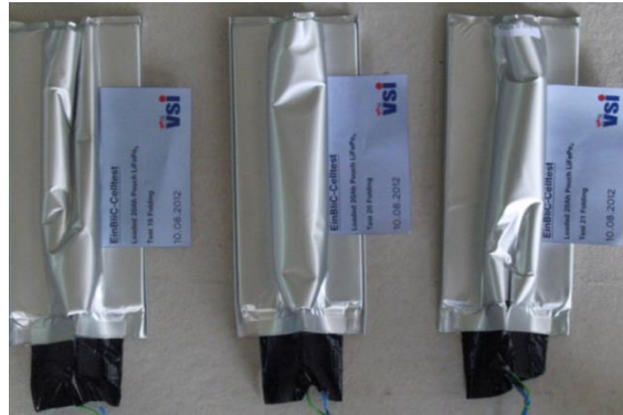
Abbildung 11.10: Verformte Batteriezellen nach Knicktest
