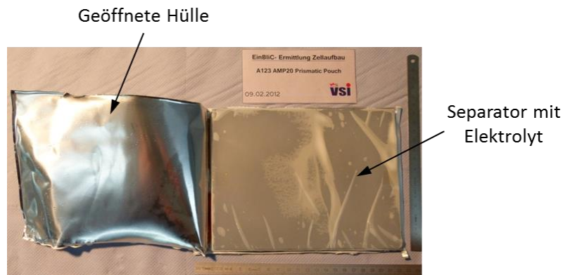
Abbildung 8.3: Batteriezelle mit geöffneter Hülle (PROJEKT INTERN VSI TU GRAZ)
