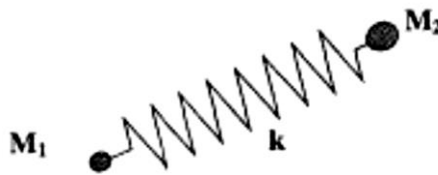
Abbildung 12.9: Eindimensionales Ersatzsystem mit Feder
