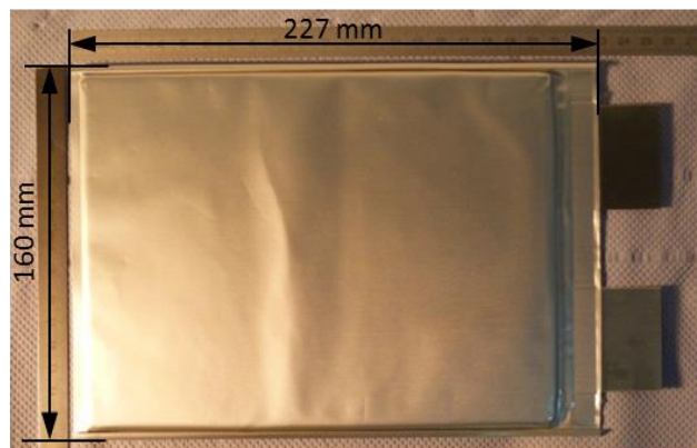
Abbildung 8.2: Gesamte Batteriezelle vor dem Zerlegen (PROJEKT INTERN VSI TU GRAZ)
