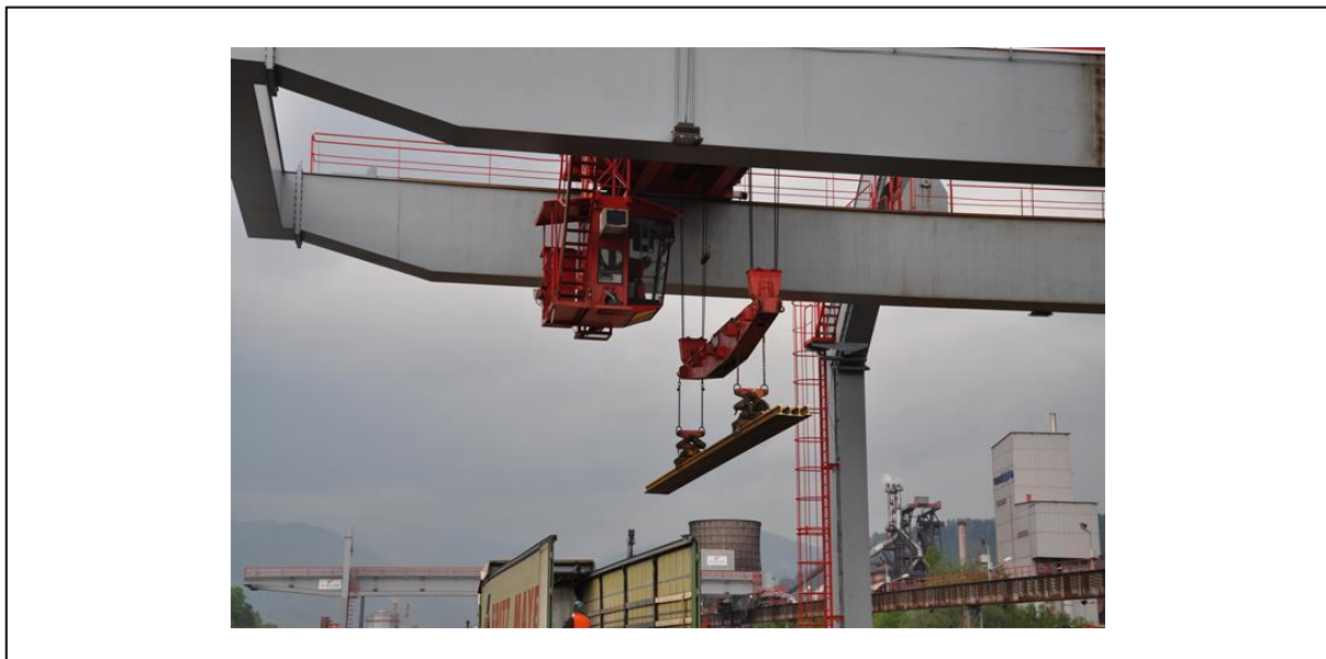
Abbildung 3-9 Portalkran zur Kurschienenmanipulation 203
