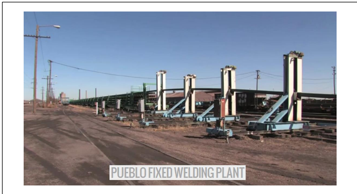
Abbildung 3-15 Verladung von Schweißlinie direkt auf Transportwaggon 209
