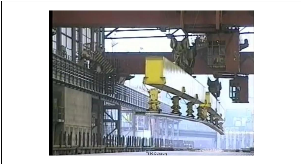
Abbildung 3-10 Synchronisierte Deckenkrane zur Langschienenmanipulation 204
