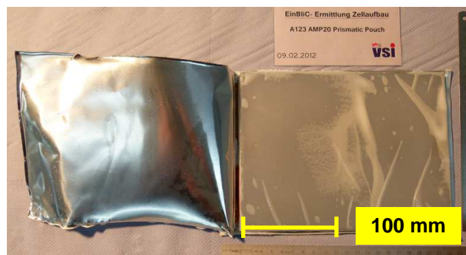
Abbildung 6.4: A123-AMP20-Zelle unmittelbar nach dem Öffnen der Pouch (PROJEKT INTERN, VSI TU GRAZ)
