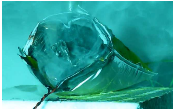
Abbildung A.3: Aufgeplatzte A123-AMP20-Zelle (Kegelpenetrationstest Nr. 4)
