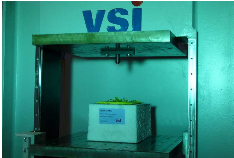
Abbildung 6.24: Versuchsaufbau Nagelpenetrationstest mit eingelegter Zelle
