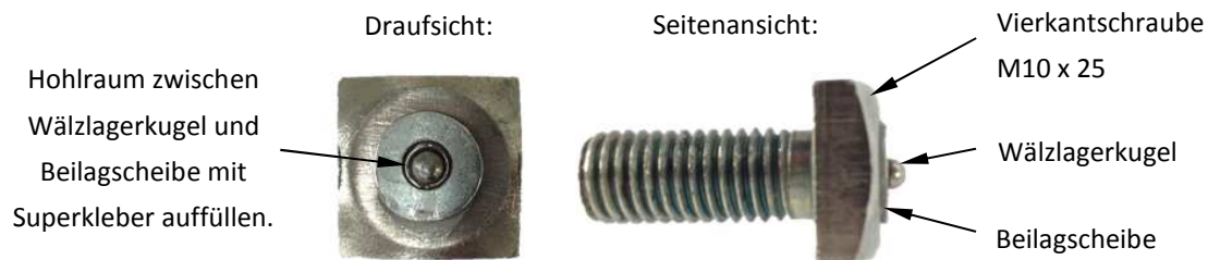
Abbildung 6.7: Kugelimpaktor für Separator-Kurzschluss-Ersatzversuche
