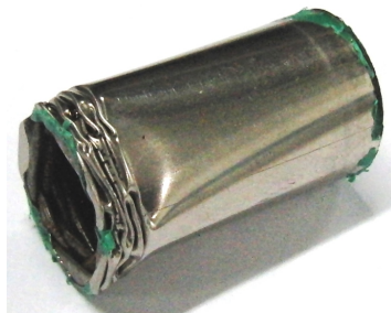
Abbildung 4.9: Deformation der Metalcan bei „Crush in Z-Richtung“.
