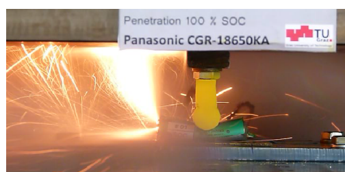
Abbildung 8.1: Reaktion einer 18650-Zelle bei mechanischer Beschädigung.
