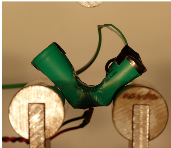
Abbildung 4.26: Deformation der Zelle nach einem 3-Punkt-Biege-Versuch.
