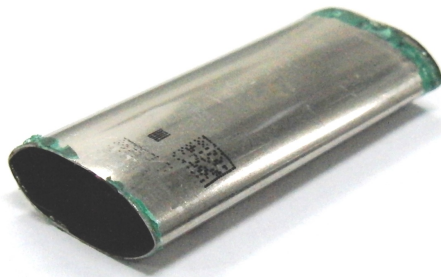
Abbildung 4.7: Deformation der Metalcan bei „Crush in X-Richtung“.
