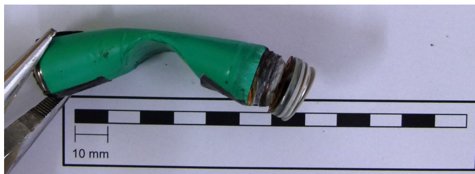
Abbildung 4.20: Deformation der Zelle nach einem Penetrations-Versuch.
