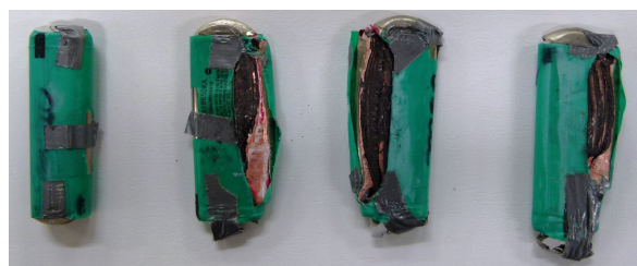
Abbildung 4.13: Zellen Nr. 01 bis Nr. 04 nach dem Test.
