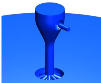
Abbildung 3-20 Berechnungsmodell der Vorkammer für den Vergleich zwischen Fire und Fluent
