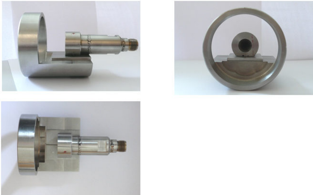
Abbildung 3-18 Gegenstromkanal für die LIF-Messungen in der Einblaskammer
