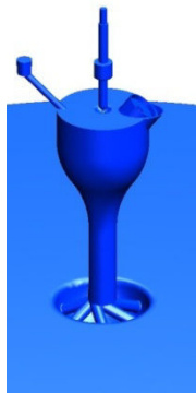
Abbildung 5-15 Berechnungsmodell der Vorkammer – Dreiloch düse und tangential angeordnete Überstromkanäle
