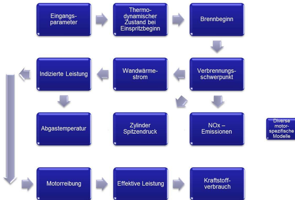
Abbildung 2-12: Ablaufdiagramm der Berechnung des Zylindermodells [8]
