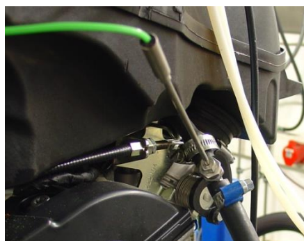
Abbildung 32: Temperaturmessstelle vor Kraftstoffinjektor
