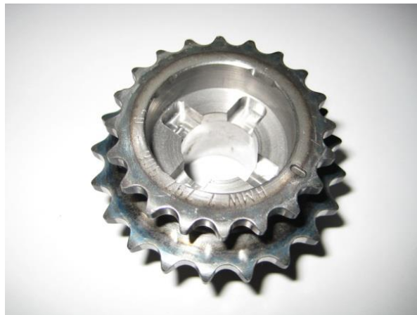
Abb. 8.12: Bearbeitetes Kettenrad der Hochdruckpumpe
