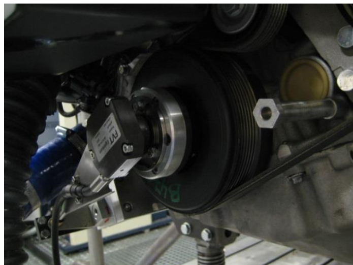
Abb. 5.9: Kurbelwellen-Drehwinkelsensor am Drehschwingungsdämpfer
