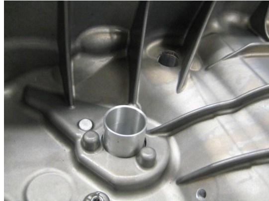
Abb. 8.17: Füllstandrohr in der Ölwanne
