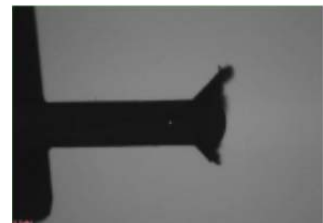
Abbildung 3-7 REM Vergrößerung der Spritzlochabdrücke
