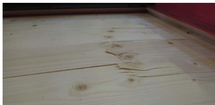
Abb. 2-3—5 Biegezugversagen in der Decklage des Prüfkörpers B_D_5s-4 [33]
