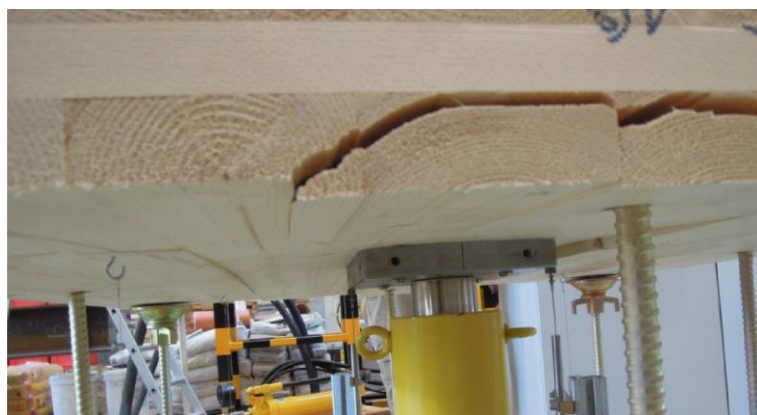
Abb. 2-3—7 Querzugversagen im Randbereich des Prüfkörpers A_D_5s-2 [33]
