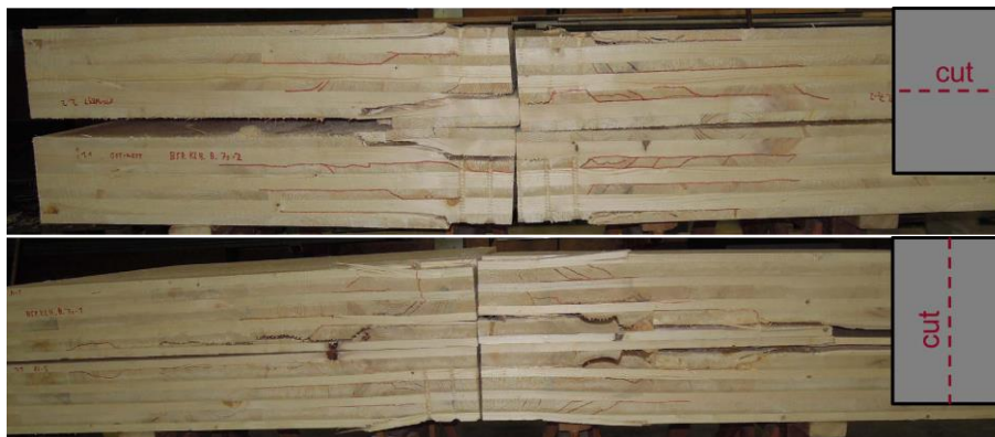
Abb. 2-3—13 Querschnitt in y-y Richtung (oben) und x-x Richtung (unten) des Prüfkörpers B_B_7s-2 [5]
