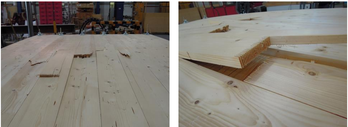
Abb. 2-3—10 Versagen mehrerer Keilzinken der Prüfkörper B_5s-1 und B_5s-2 [5]
