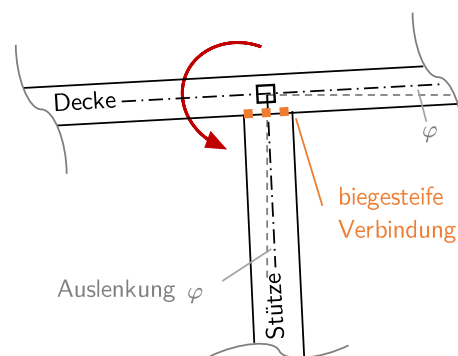
Abb. 3-1—1 Systemskizze – biegesteife Anbindung des Stützenkopfes
