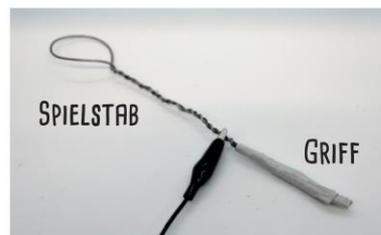
3) Als nächstes werden die Krokodilklemmen an den Parcours, den Griff und den BBC micro:bit angeschlossen. Es werden 2 Kabel benötigt. Um den Parcours „unter Strom“ zu setzen, muss ein Ende an Pin 0,1 oder 2 und das andere Ende mit dem Plastelin (beim Start) oder der Alufolie verbunden werden. Das zweite Kabel muss am (leitenden Teil des) Spielstabes und am Ground (GND) Pin des BBC micro:bit angeschlossen werden.
