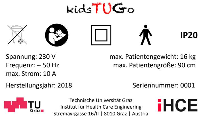
Abbildung 4.5.: Typenschild des „kidsTUGo“
