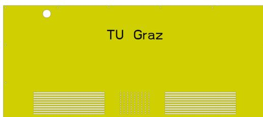
Abbildung 3.36.: Seitenverkleidung der Seitenwand mit Bohrung für die Kurbel der Seilwinde
