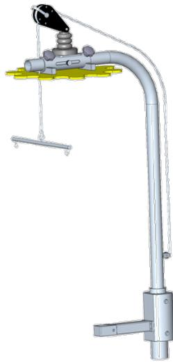
Abbildung 3.40.: Halterohr für Patientenstützvorrichtung mit Platte für Halterung des Seilzugs und Verbindungsstück zur Orthesenhalterung (Stabilitätsverbesserung)
