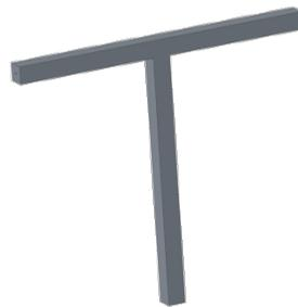
Abbildung 3.45.: Höhenverstellbares T-Stück für Orthesenhalterungen
