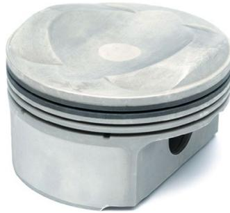
Abbildung 4.2: Exemplarischer Kolben für einen Ottomotor mit Direkteinspritzung (van Basshuysen und Schäfer, 2017, S. 110, Abb. 7.6).
