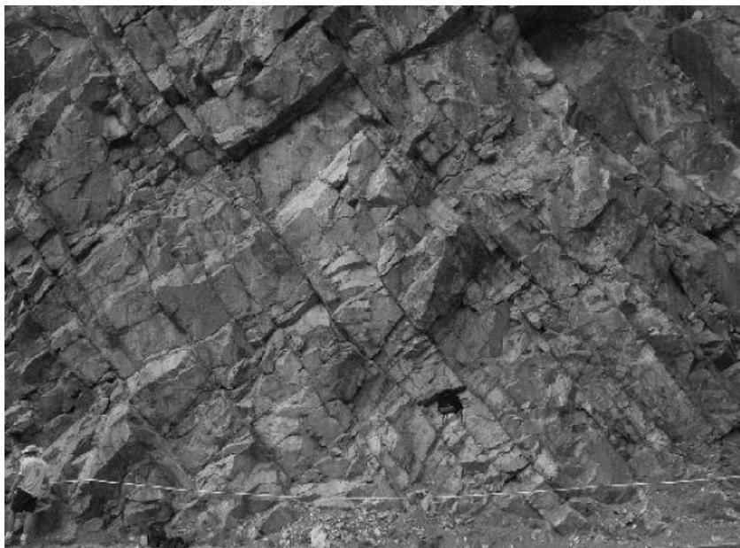
*Abbildung 6: Aufnahme des Gebirges mit der Scan Line Methode (Liu, Rock Mass Characterization 2014)*
