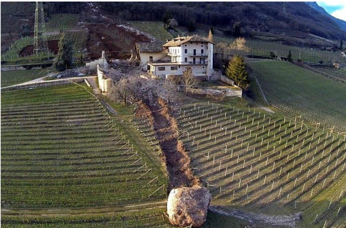
Abbildung 4: Foto eines Felssturzes in der Nähe von Tramin, Südtirol. Gut zu erkennen ist, dass die kleineren Felsbrocken, im Hintergrund des Fotos, noch vor dem Haus liegengeblieben sind, wohingegen der große Block wesentlich weiter und durch das Gebäude hindurch gedonnert ist (spiegel.de, 2014).
