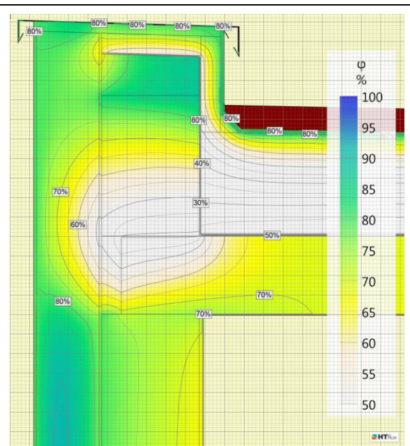
Abb. 73: A_AW01 Var. Gefälledämmung Feuchte
