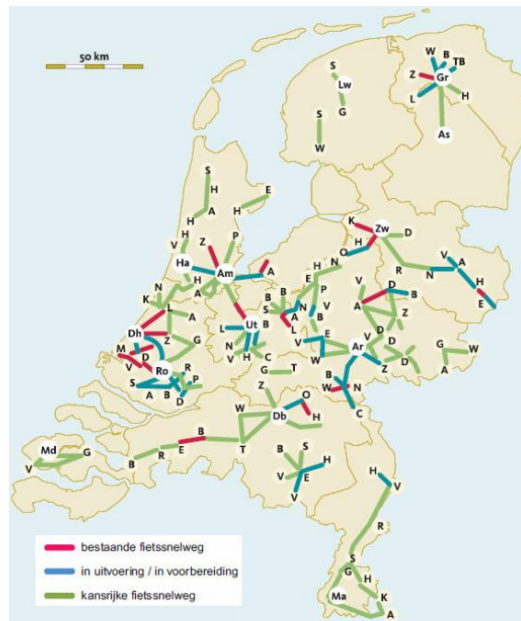
Abbildung 24: Radschnellstreckennetz in den Niederlanden (rot=Bestand, blau = in Planung und Bau, grün = mögliche zukünftige Radschnellstrecken) [Spapè, 2016]
