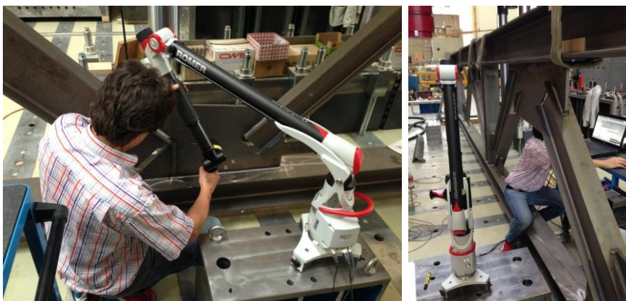
Bild 110: Aufnahme der realen Geometrie mithilfe eines 3D-Photogrammetriesystems (System Romer)
