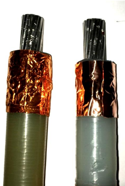
Bild 7-9: Vergleich zwischen dem gealterten (links) und dem neuen Kabel (rechts)
