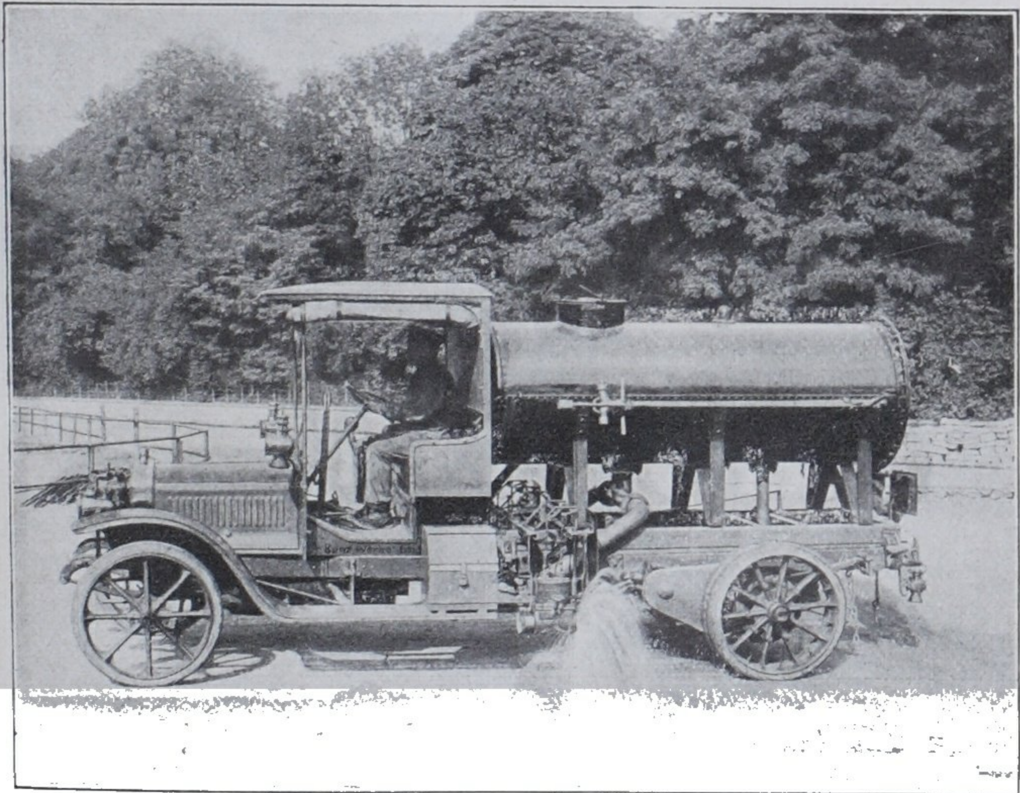
Abb. 47. Auto-Sprengwagen mit 1500 Liter Inhalt.
