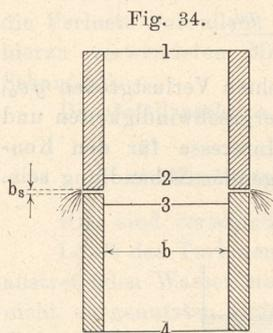
Es leuchtet ohne weiteres ein, daß die Menge des Verlustwassers <sup>1)</sup> von dem an der Übergangsstelle 2—3 vom Leitrade und Laufrade herrschenden hydrostatischen Drucke des Wassers abhängt. Weiter ist die Größe des Spaltes und die Form desselben von Einfluß.
