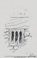
Abb. 12. Niedersept. Kellerfenster in Eichenholz.
