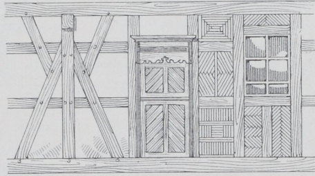
Abb. 17 und 18. Typen von Verstrebung und Gefachfüllung.
