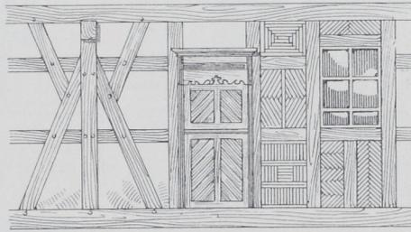
Abb. 17 und 18. Typen von Verstrebung und Gefachfüllung.
