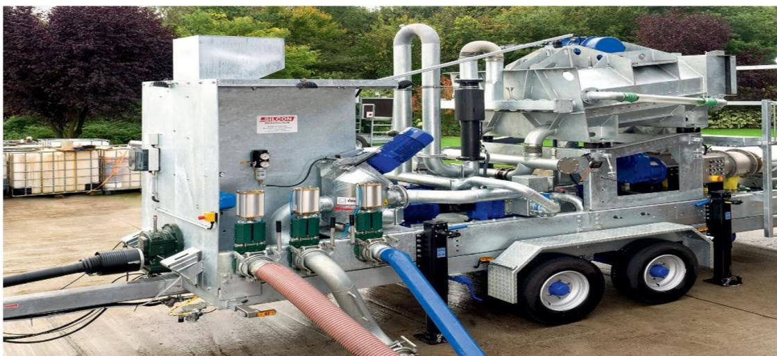
Abbildung 4-13: Mobiles Vibrationssieb V<sub>2</sub>S mit integrierter Pressschnecke (SILCON GmbH & Co.KG, 2017)
