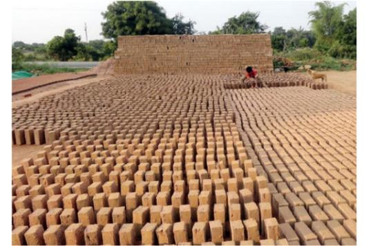
Abb. 134 | Lehmsteine trocknen in der Sonne. Sie können einfach von Hand geformt und anschließend bis zum Erhärten luftgetrocknet werden.
