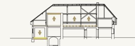
Bereich Schnitt D-D: im OG: Einziehen einer neuen Deckenkonstruktion im Dachraum, Erhöhung der Fußbodenaufbauten über niedrigen Bestandsdecken, Anheben der bestehenden Holzdecke der östlichen Dachkammer
