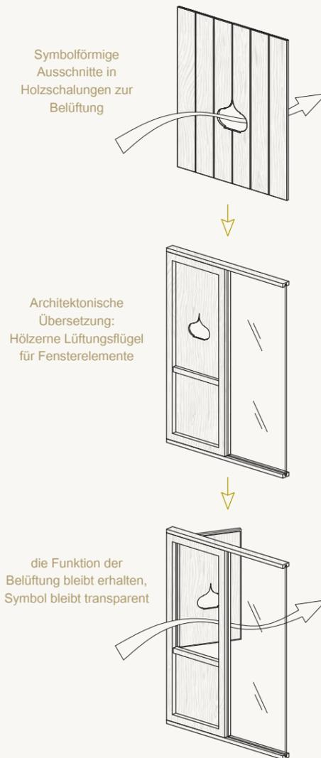
Abb. 223 | Lüftungselemente
