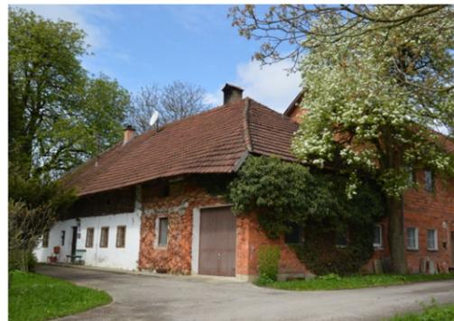
ist das neue Dach auf einer Giebelwand aufgesattelt, im Norden abgewalmt. Die Dachneigung ist mit  $37^\circ$  nur unwesentlich geringer als im Bestand mit Neigungen zwischen  $40$  und  $45^\circ$ .
