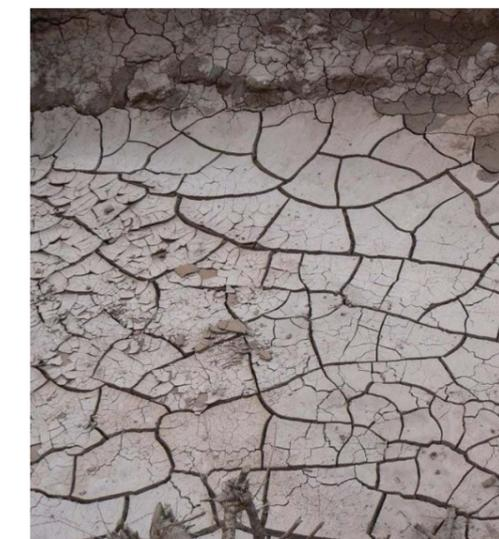
Abb. 139 | Tonerde mit trocknungsbedingten Schwindrissen.
