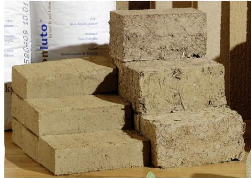
Abb. 149 | Schwere Lehmsteine für tragendes Mauerwerk (links) und mit Fasern versetzte Leichtlehmsteine (rechts)
