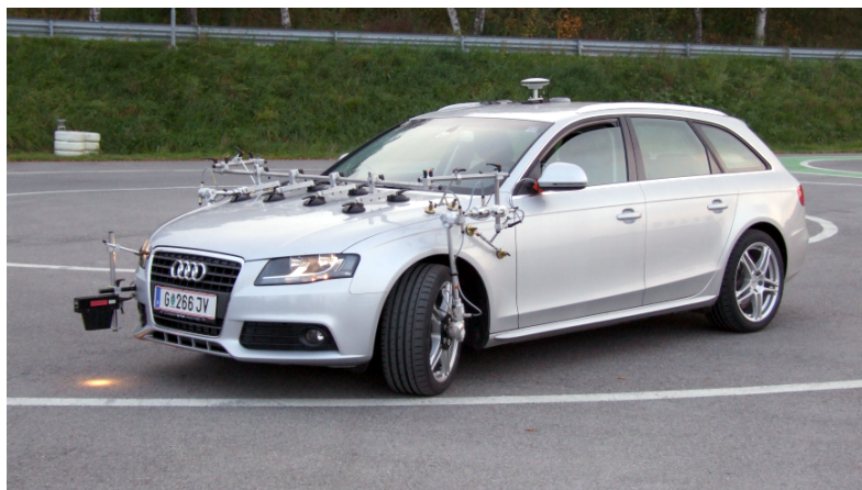
Abbildung 4.1: Versuchsfahrzeug zur Erfassung des fahrdynamischen Zustandes
