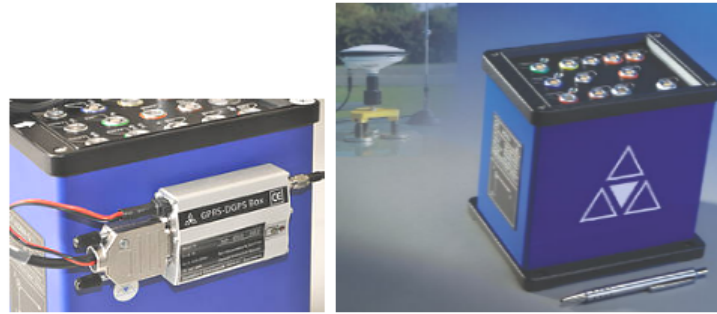
Abbildung 4.4: Kreiselplattform ADMA-G-PRO+ (rechts) und GPRS-DGPS-Box zur exakten Messung der dynamischen Bewegungszustände (links) [20]
