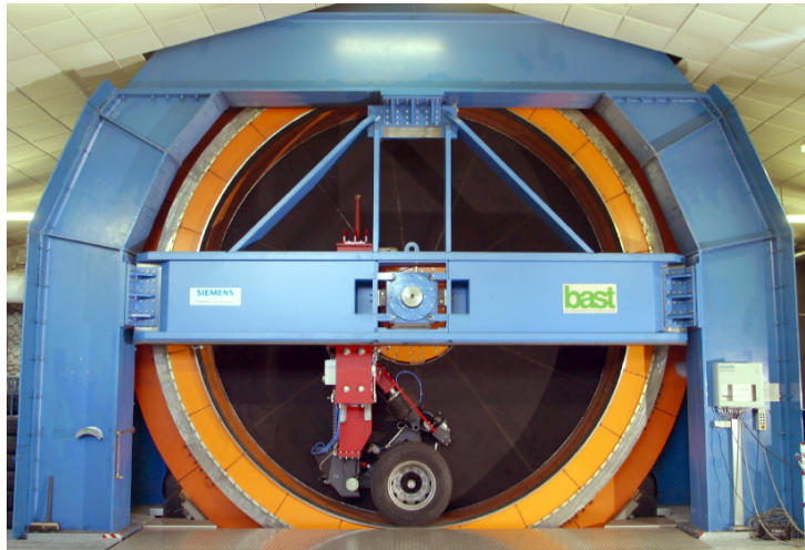
Abbildung 2.10: Der Innentrommelprüfstand ermöglicht die Untersuchung des Reifens auf verschiedenen Fahrbahnoberflächen [7]
