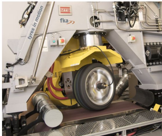
Abbildung 2.12: Der Flachbahnprüfstand ermöglicht durch eine ebene Fahrbahn die Untersuchungen bei realistischem Reifenlatsch [15]
