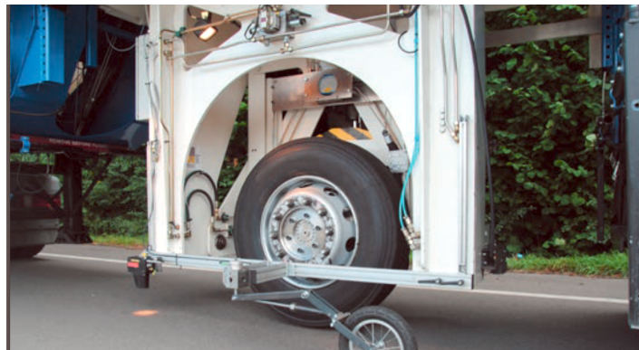
Abbildung 2.13: Der mobile Prüfstand ermöglicht die Ermittlung der Reifeneigenschaften auf der realen Fahrbahn [35]
