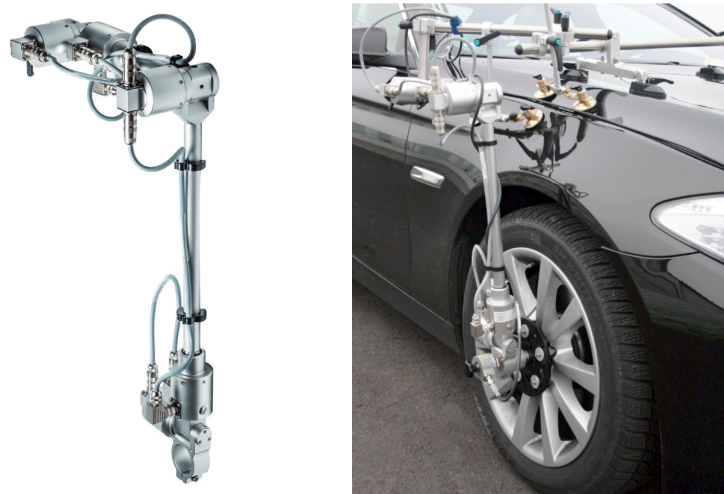
Abbildung 4.6: Radvektorsystem zur Bestimmung der Radbewegung relativ zum Fahrzeugaufbau; links: RV-4 Sensoren; rechts: Anbau am Fahrzeug [47]
