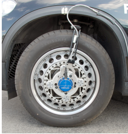
Abbildung 2.14: Mit Radkraftmessfelgen werden die am Rad wirkenden Kräfte und Momente im Fahrbetrieb bestimmt [74]
