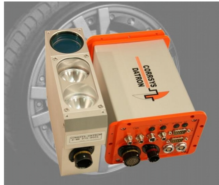
Abbildung 4.3: Geschwindigkeitssensor Correvit S-HR zur Schwimmwinkelmessung [44]
