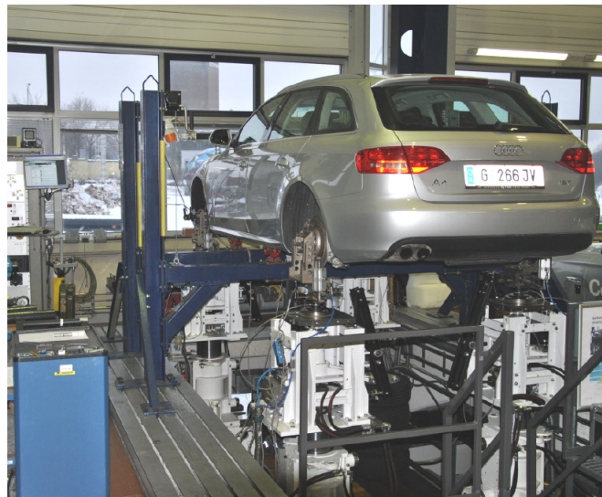
Abbildung 5.14: Versuchsfahrzeug am Achsmessprüfstand zur Bestimmung der Kinematik und Elastokinematik
