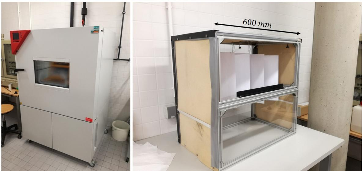
**Abbildung 27:** Klimaschrank. Links ist der Klimaschrank zu sehen in welchem Temperatur und Luftfeuchtigkeit eingestellt werden kann. Der Einbau der benötigt wird um die Probe vor Luftzügen zu schützen besteht aus einem Aluminiumrahmen und drei Seiten sind mit Filzen verkleidet. Die Rückwand und die vordere Seite sind mit einer Plexiglasscheibe versehen.
