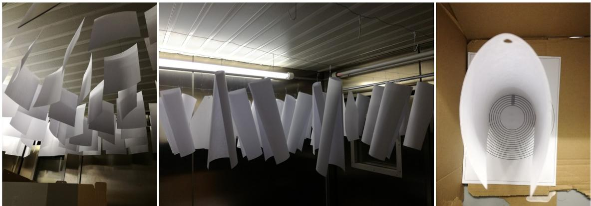
**Abbildung 25:** Klimabox. Die linke Abbildung zeigt die Anbringung der A4-Proben an der Decke des begehbaren, klimatisierbaren Raums. In der Mitte sind die Proben abgebildet nachdem der höchste Wert der Luftfeuchtigkeit (90%) erreicht war. Die Proben zeigen eine sehr starke Wölbung. Die Messung der Wölbung erfolgt über die bereits vorgestellten Schablonen, wie im rechten Bild zu sehen ist.
