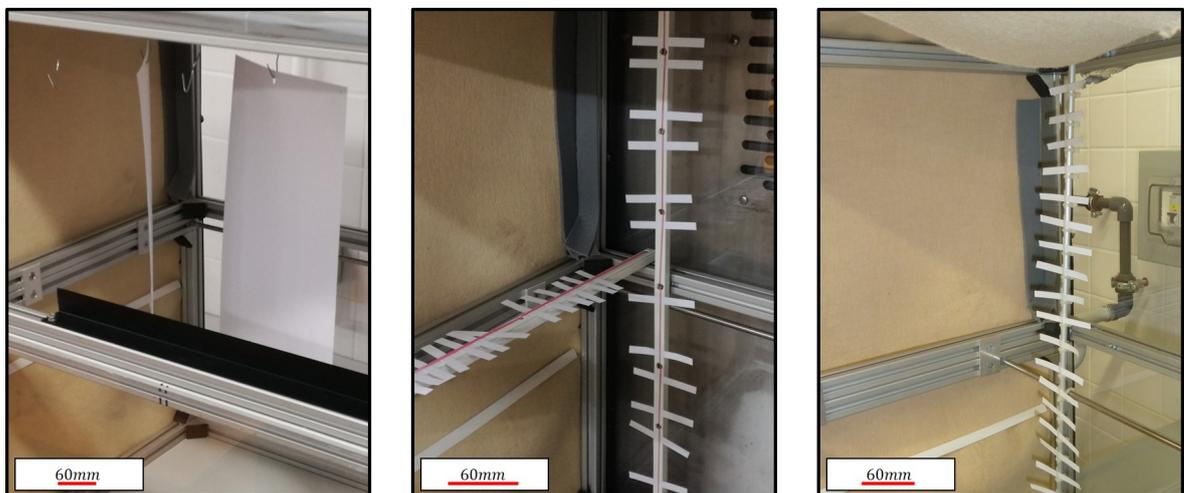
**Abbildung 28:** Drei Möglichkeiten zur Anbringung der Proben im Klimaschrank. Links: Aufhängung von A4-Proben an der Decke des Einbaus. Mitte: Anbringung von Proben der Größe 6 x 60 mm an einem rechteckigem Kunststoffprofil. Ein Gummiband dient der Fixierung der Proben. Rechts: Die Proben werden mit Kunststoffhalterungen auf einem runden Aluminiumprofil angebracht.
