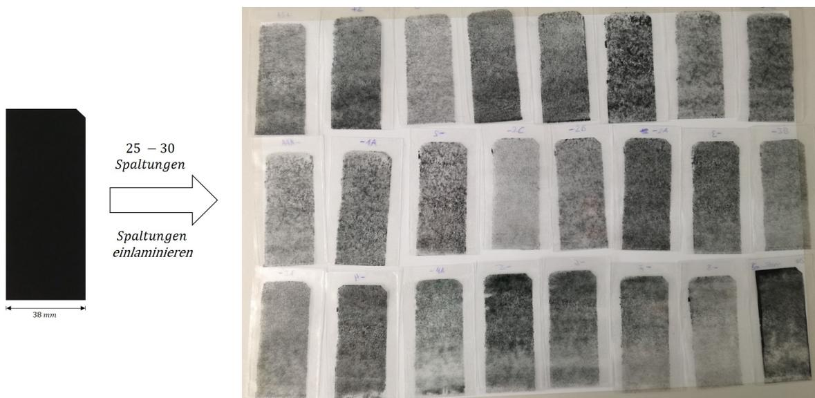
**Abbildung 22:** Die eingefärbte Probe wird in 20-30 einzelne Schichten gespalten. Diese einzelnen Schichten werden zwischen zwei Folien einlaminiert.
