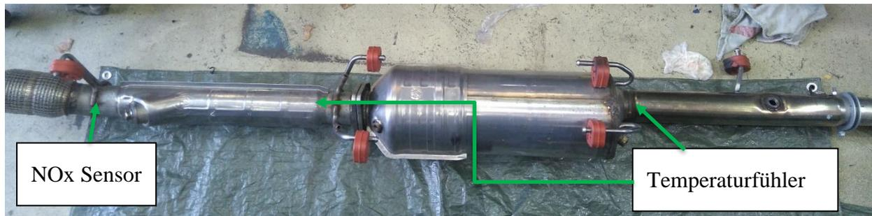
Abbildung 4-8: Ausgebauter SCR-Katalysator mit gekennzeichneten Stellen für die Sensoren
