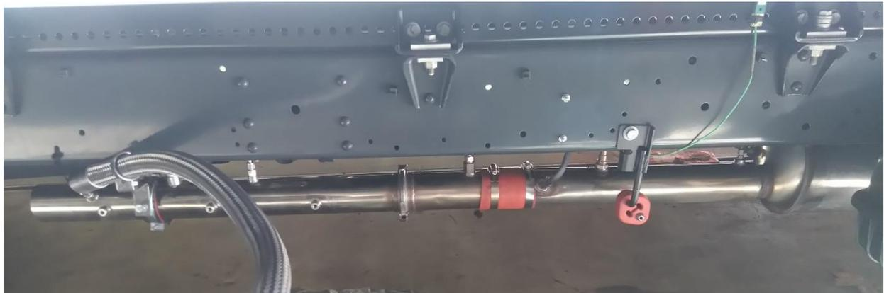
Abbildung 4-9: Eingebauter SCR-Katalysator mit EFM
