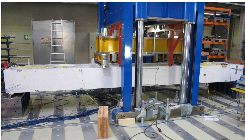
Abbildung 2.3: Seitenansicht des Biegeträgers im 4-Punkt-Prüfgerüst. am LKI
