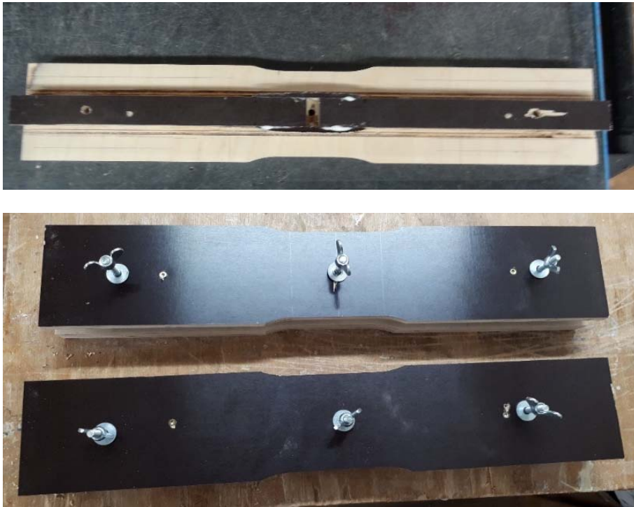
Abbildung 3-8: Frässchablonen; oben: Grundplatte mit Mittelsteg; unten: Frässchablonen mit Spanndeckel und Spannschrauben
