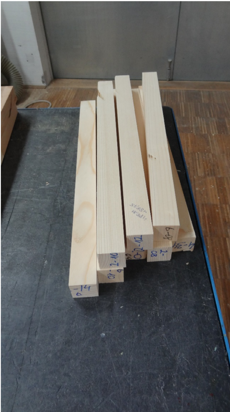
Abbildung 3-4: Rohlinge der Prüfkörper für die longitudinale Belastungsrichtung
