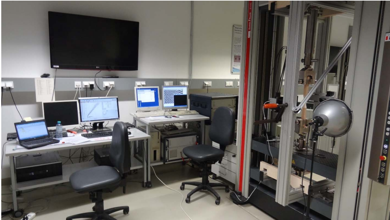
Abbildung 3-11: Prüflabor der BOKU mit Universalprüfmaschine, den Speckle-Kameras und den Computern für Steuerung und Auswertung
