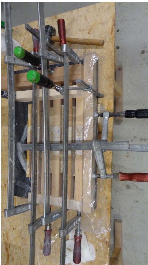
Abbildung 3-7: Weiterverarbeitung zu Prüfkörpern mit radialer Belastungsrichtung; links: während des Verklebens mit der Lasteinleitung; rechts: nach dem Ausspannen
