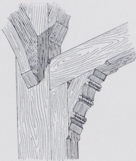
Abb. 10. Hängemühle bei Diepholz. Ständer, Flettholz und Kopfband am Flett.
