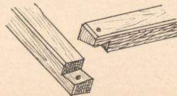
Abb. 15. Verbindung der Schwellen.
