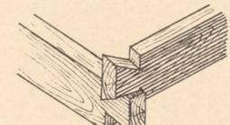
Abb. 14. Eckverbindung der Bohlen.
