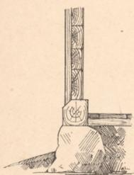
Abb. 3. Schnitt durch die Bohlenwand.
