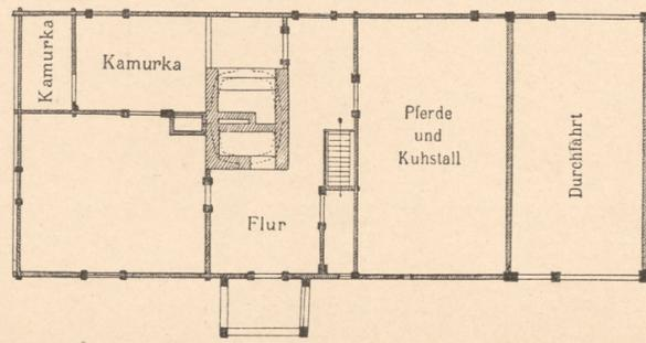
Abb. 6. Grundriss des Hauses D.
