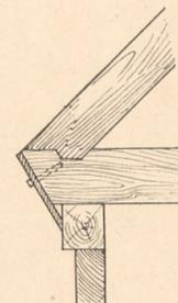
Abb. 4. Verbindung der Sparren mit dem Balken.
