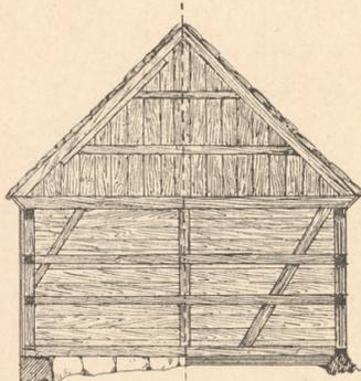
Abb. 10. Scheune. Querschnitt.
