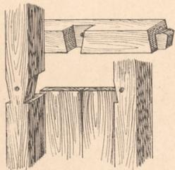
Abb. 12. Stiel- und Riegelverbindung bei doppelten Thüren.
