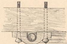
Abb. 15. Obere Führung der Scheuenthür.
