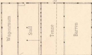
Abb. 7. Grundriss der Scheuer C.
