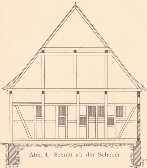
Abb. 4. Schnitt ab der Scheuer.
