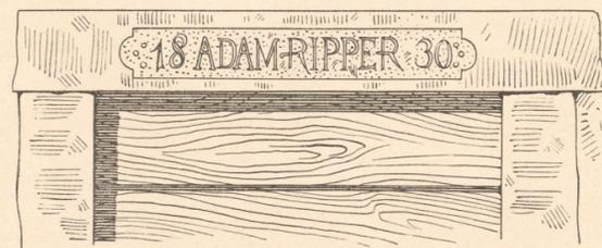
Abb. 8. Thürgerüst am Kuhstall. (Massstab 3 : 50.)
