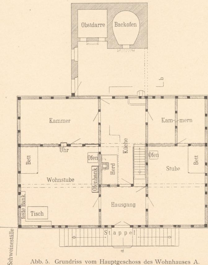
Abb. 5. Grundriss vom Hauptgeschoss des Wohnhauses A.
