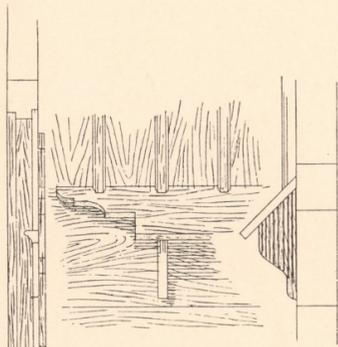
Abb. 7. Abschluss der Giebelverschalung in Abb. 3.
