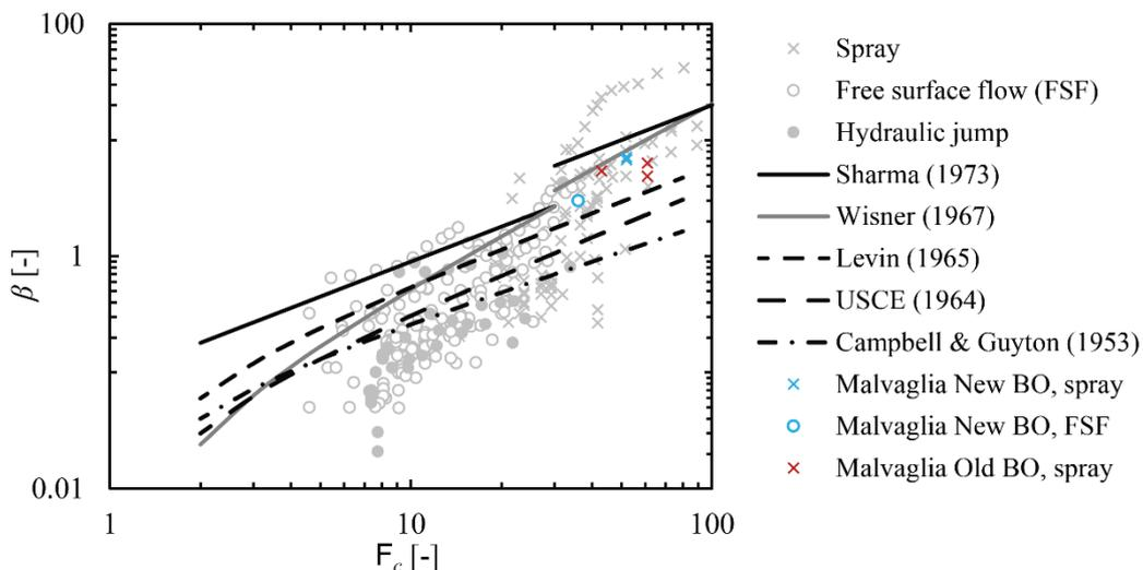
Fig. 1 Comparison of new prototype air demand measurements with existing data and equations. Comparaison des nouvelles mesures de la demande d'air en prototype avec des données existantes et des équations.
